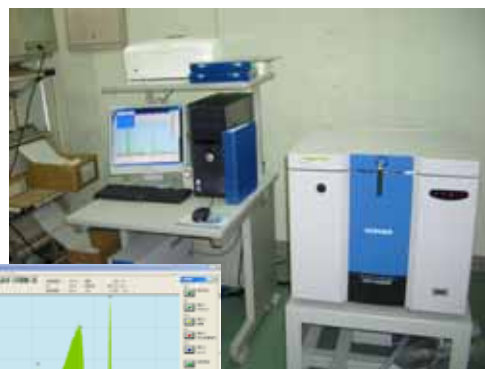
有害元素蛍光X線検査装置 (RoHS指令6物質の含有測定)
