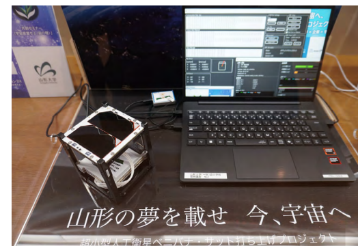
山形県産業科学館に展示された「ベニバナ・サット01号 地上試験モデル」
