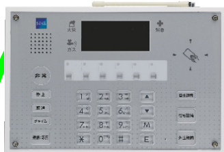
非接触ICカード対応でインターネット接続が可能な ホームセキュリティ送信機 SHA-5000/SHA-5000C (写真は SHA-5000C)
