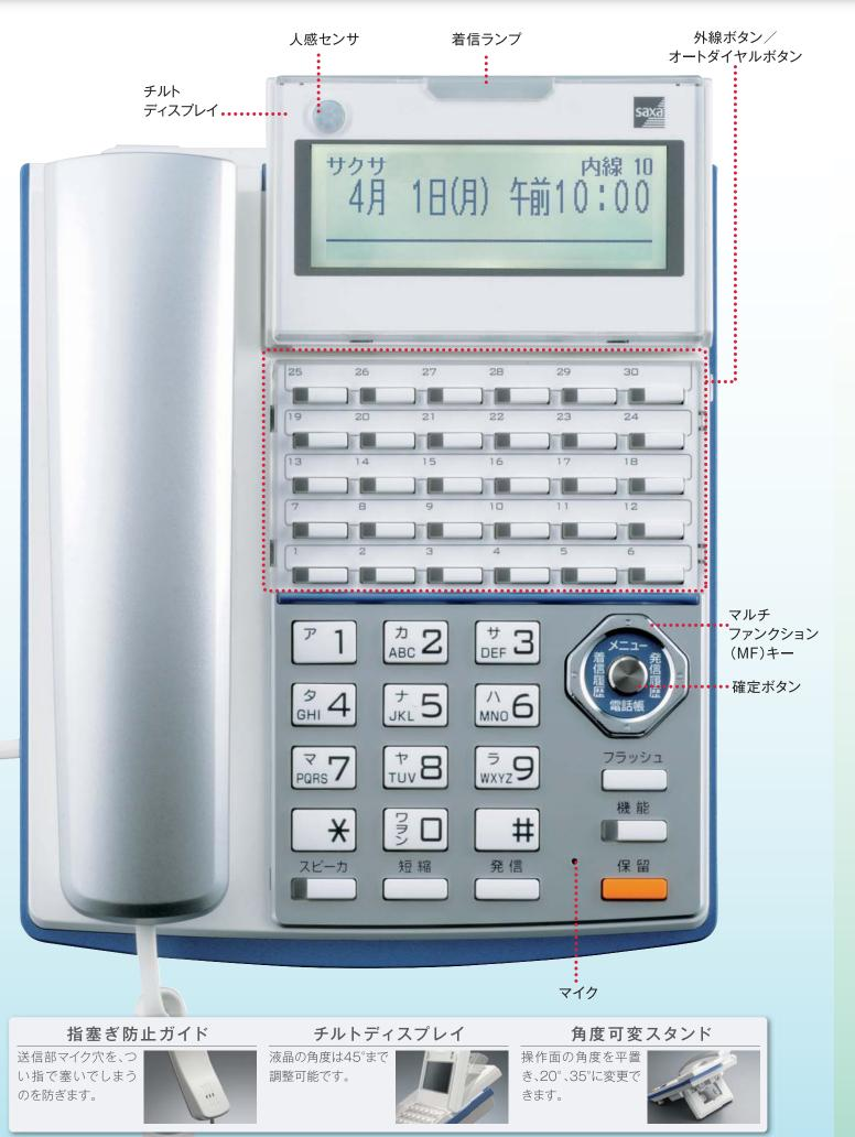
サイズ:約51×38×212mm 質量:約150g 通話連続時間:約8時間 待受連続時間:約24時間 充電完了時間:約8時間以上 電話帳利用:10,000件
